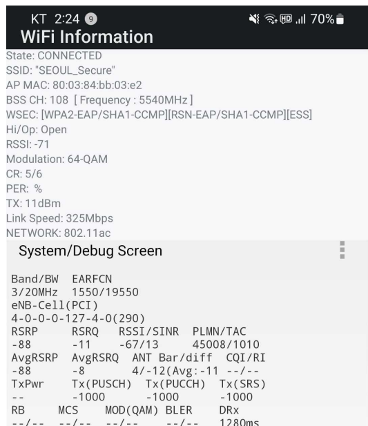
그림 2. 안드로이드 커널에서의 무선통신망 정보 확인 Fig. 2. Checking network information in the Android kernel
