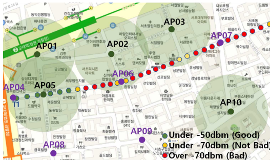
그림 13. 5개의 AP 이상 상황에서, 위치별 통신상태 측정 결과 Fig. 13. Communication condition results in tracker's each point
